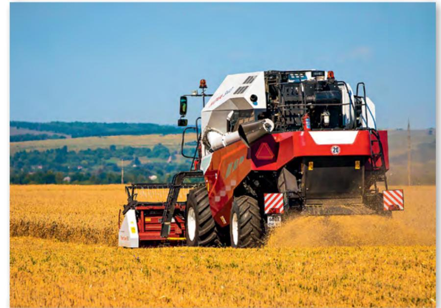
В ХОДЕ ИСПЫТАНИЙ ЧИСТОТА ЗЕРНА ЯРОВОГО РАПСА В БУНКЕРЕ КОМБАЙНА ПРИ ВСЕХ РЕЖИМАХ ЕГО РАБОТЫ НАХОДИЛАСЬ В ПРЕДЕЛАХ 97,64–97,94 ПРОЦЕНТА, СОИ — 98,04–98,06 ПРОЦЕНТА, ПРИЧЕМ В ОБОИХ СЛУЧАЯХ ПОКАЗАТЕЛИ ОТВЕЧАЛИ КАТЕГОРИЯМ ОРИГИНАЛЬНЫХ И ЭЛИТНЫХ СЕМЯН
